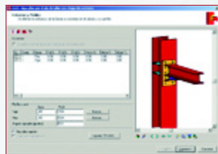
Esforços e perfis: definem-se os perfis para as barras a unir e os esforços a considerar no cálculo.
